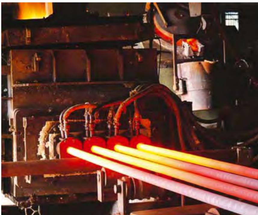
Figura 8.54 - Barras de ferro nodular produzida em fundição contínua<sup>27</sup>.
