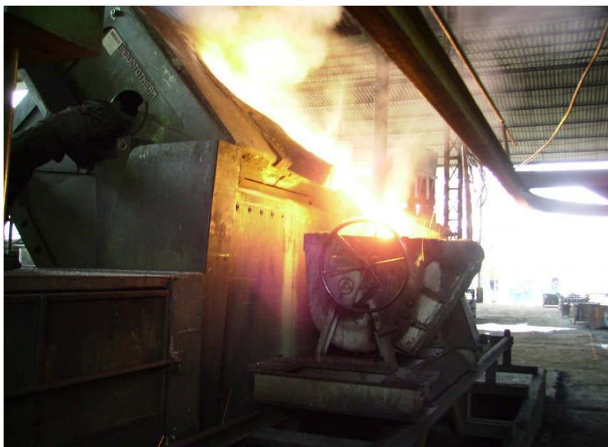
Figura 8.55 - Forno cubilô e panela de espera<sup>29</sup>.
